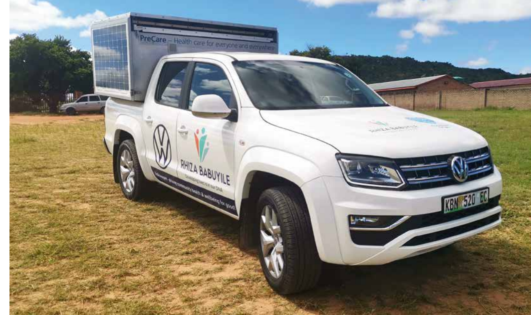
Der erste Prototyp der Versorgungseinheit, die auf einen Volkswagen Amarok montiert wurde.
