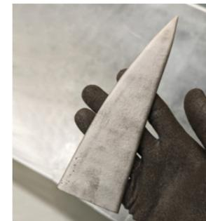
Im Auftragschweißverfahren gedruckte Zinke für das Minenräumgerät
